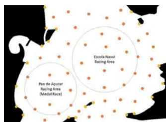
Abb. 3: Beispiel der Strömungsdatenerfassung bei den Olympischen Spielen 2016 in Rio de Janeiro, Brasilien (links) und der Gitterkonstruktion für die Interpolation mittels der FINITE-ELEMENTE-METHODE (rechts). Die orangenen Kreise entsprechen Drifter-Messungen, während die gelben Kreise benutzerdefinierte Begrenzungspunkte sind. Die Kreise kennzeichnen die Rennbereiche und die blauen Segmente stehen für die Kanten des Dreiecksgitters.
