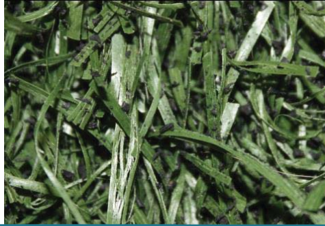
Wettbewerbsprodukt nach 30 000 Doppelhübe im Lisport, (Simulation 5 Jahre mittlere Belastung). Produktionsstandort USA
