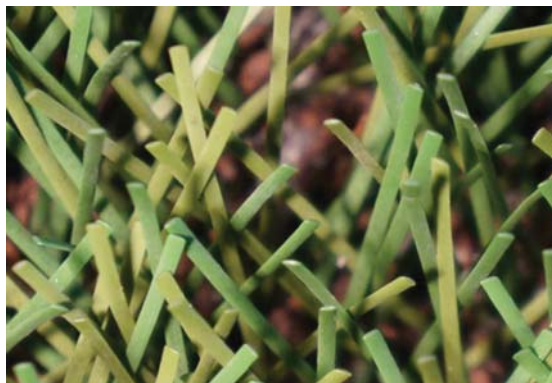
FieldTurf 360 nach Bewetterungstest (DIN Spec) und 150 000 Doppelhübe im Lisport (Simulation 15 Jahre extreme Belastung / oder 20 Jahre mittlere Belastung)
